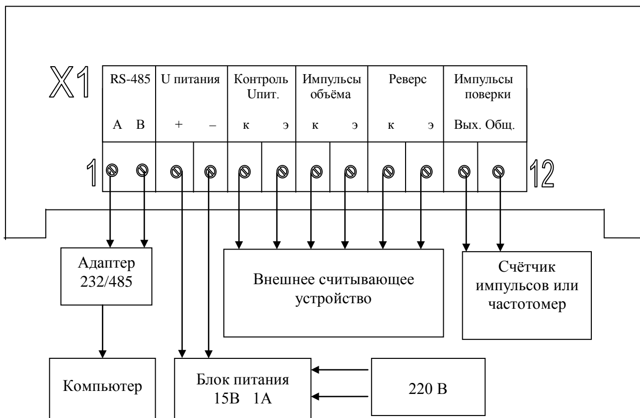
Рис.2. Схема подключения блока питания и внешних устройств (вычислителя тепловой энергии ВТЭ-1 П и персонального компьютера ПК).
